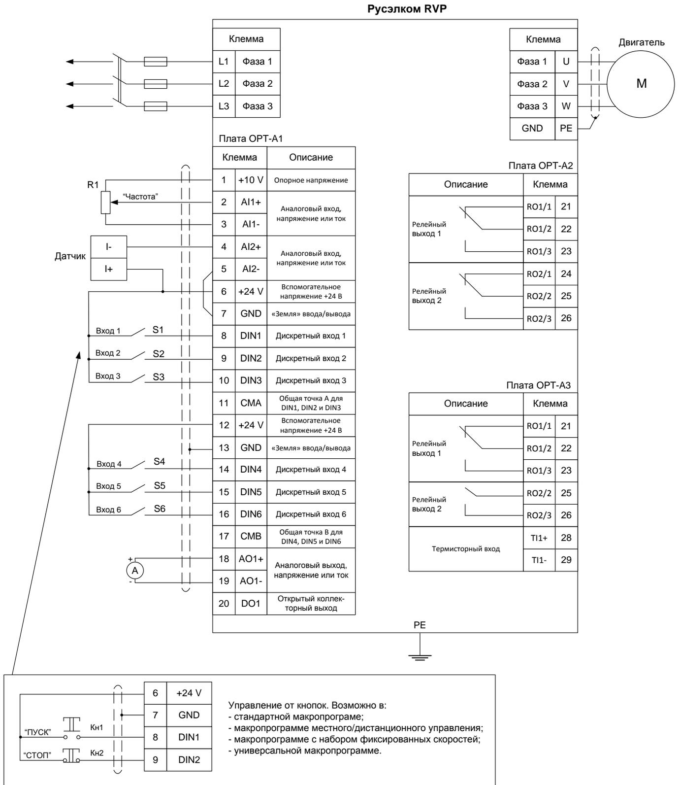
Рисунок 1 – Схема подключения внешних цепей к Русэлком RVP
